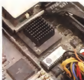
A sinistra: dettaglio sul processore 68040, fornitura di stato, e sulla EPROM del firmware. A destra: il DSP 56001
